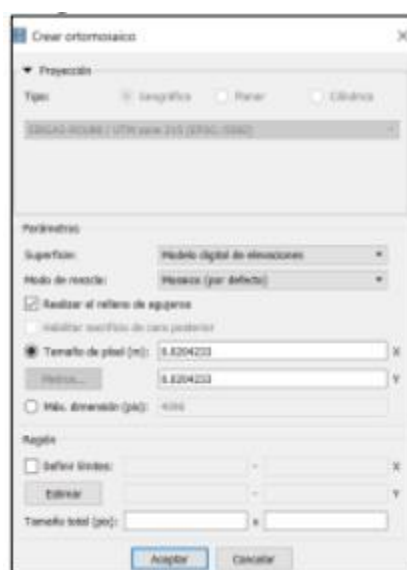
Ilustración 13 Parámetros para la generación del orto mosaico
