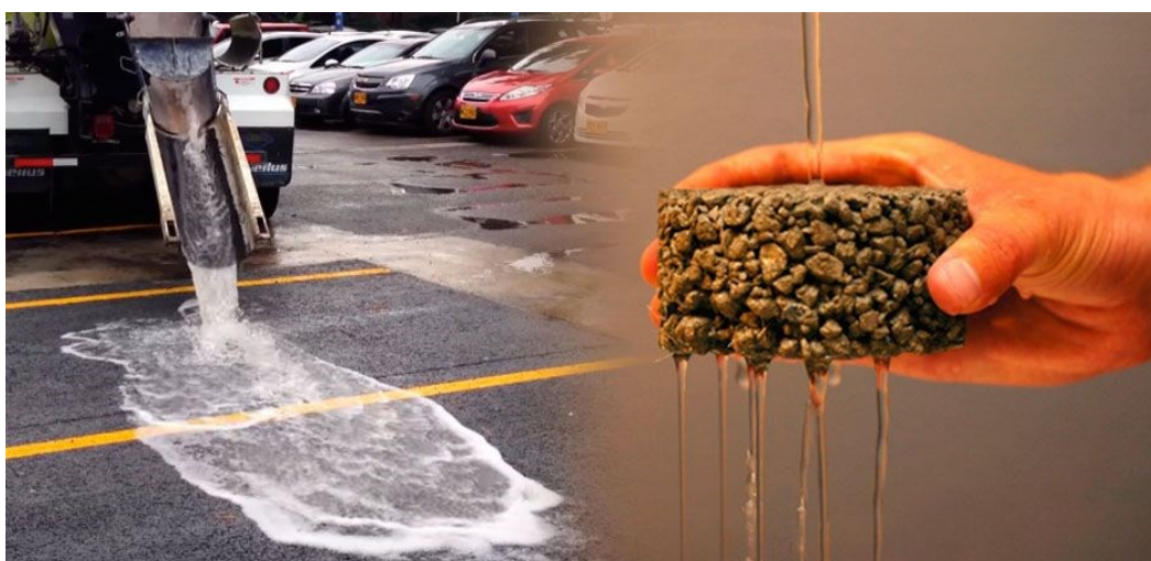
Figura 30 Como es el pavimento permeable
