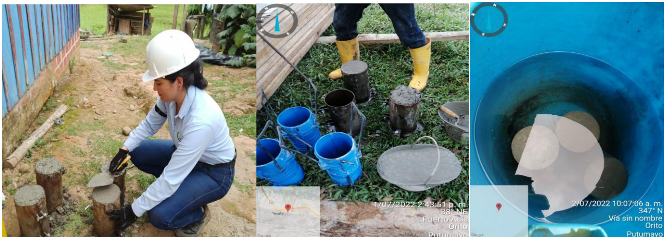
Ilustración 29 Ensayos de resistencia concreto tipo D, 3000 psi. Fuente: propia
