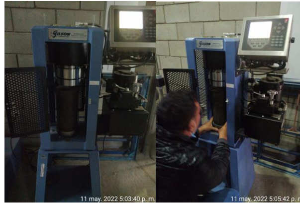
Fotografía 12. Cilindros en máquina para ensayo de resistencia a la compresión
