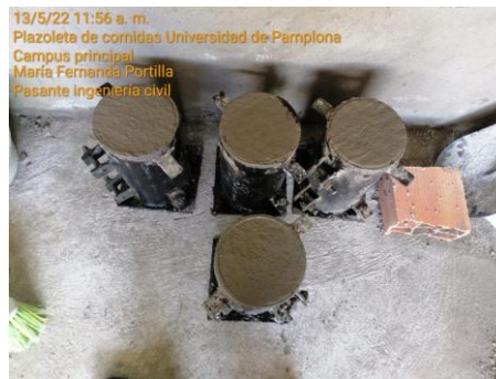
Fotografía 13. Muestra de cilindros de concreto de placa en camisas metálicas
