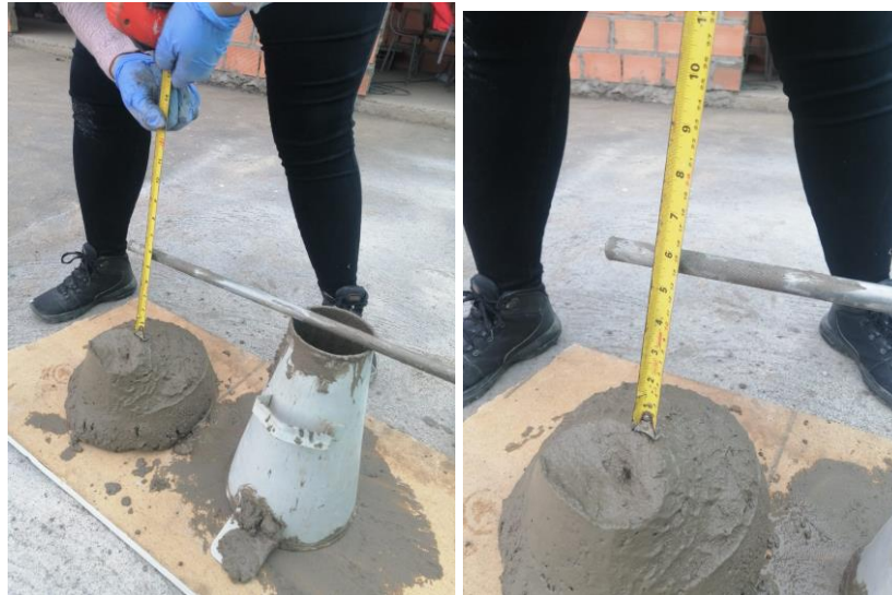
Fotografía 8. Asentamiento del concreto Fotografía 9. Medida de asentamiento de concreto
