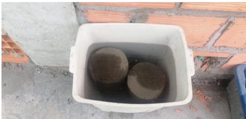
Fotografía 11. Cilindros de concreto en proceso de curado
