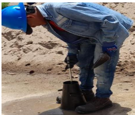
Ilustración 17. Medición del asentamiento.
