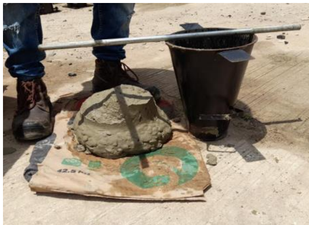
Ilustración 18. Asentamiento del concreto.
