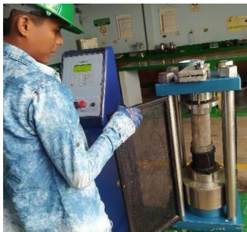
Ilustración 21. Cilindro en máquina para ensayo de resistencia a la compresión.
