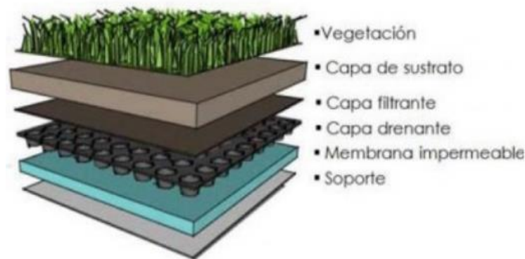
Figura 4. Componentes de los techos verdes. Fuente: (Valbuena y Tibasosa, 2016)
