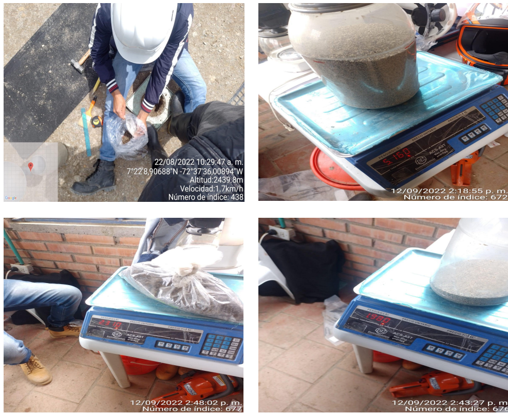
Figura 21. Ensayo densidad en el sitio realizado en campo, con mejoramiento de la compactación
