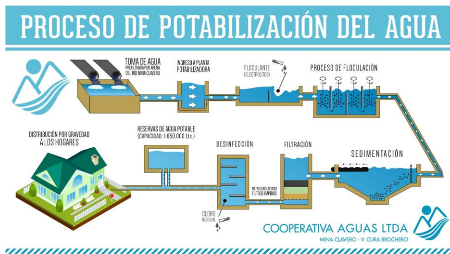
Ilustración 2. Proceso para la potabilización del agua
