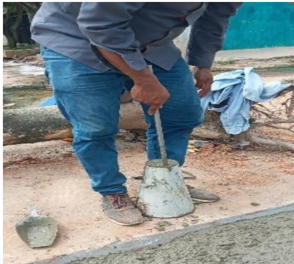
Figura 19. Compactación de la muestra de concreto
