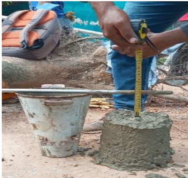
Figura 20. Asentamiento de la muestra de concreto
