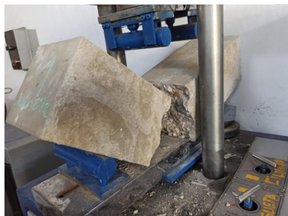
Ilustración 28: ensayo in situ de resistencia y fallo de la viga.
