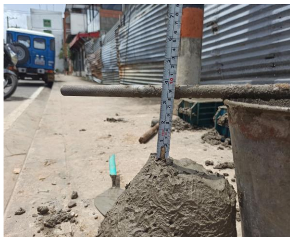
Ilustración 27: asentamiento cono de Abrams
