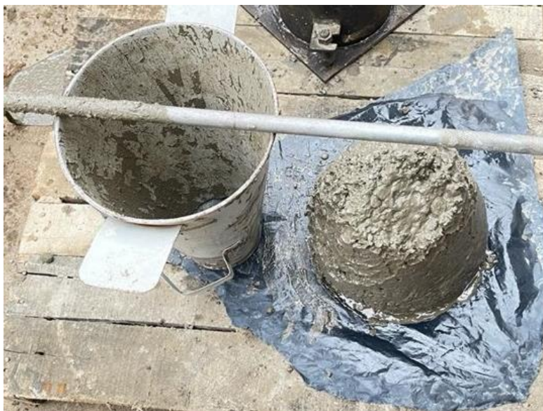
Ilustración 12-: Ensayo asentamiento de la mezcla.
