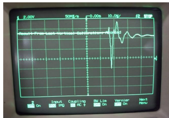
Figura 22: Forma de onda de salida IM etapa 3 y fenómeno de Gibbs
