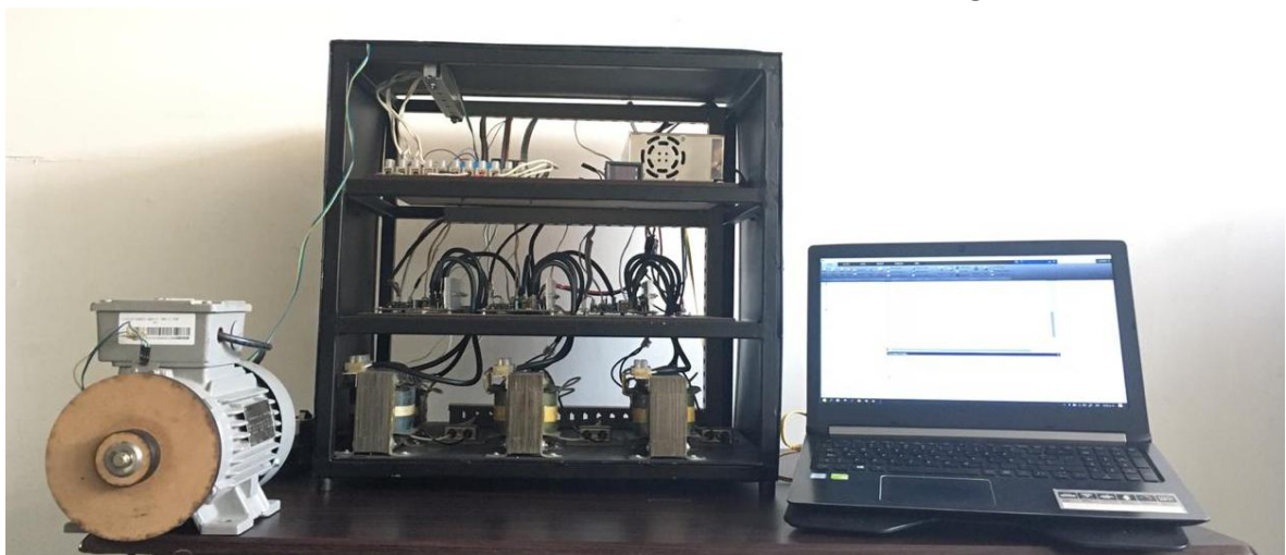
Figura 54: Montaje experimental de control vectorial de campo orientado
