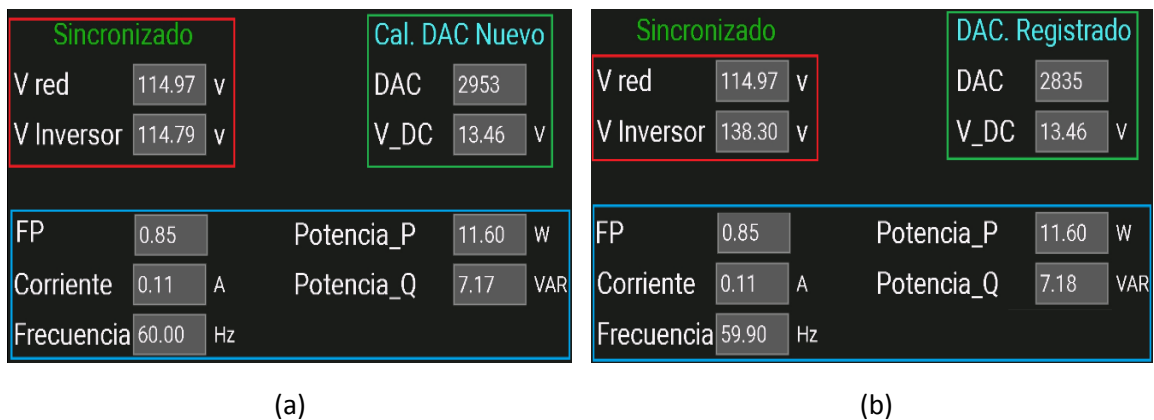
Figura. 59 Control difuso en el voltaje del inversor
