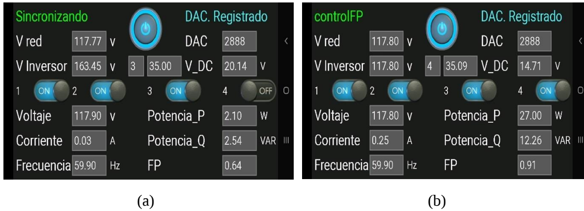
Figura. 68 Control del Factor de Potencia mediante el control P&O
