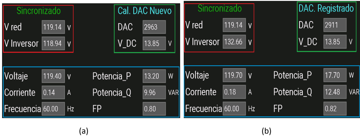
Figura. 63 Sincronización con voltaje RMS de compensación
