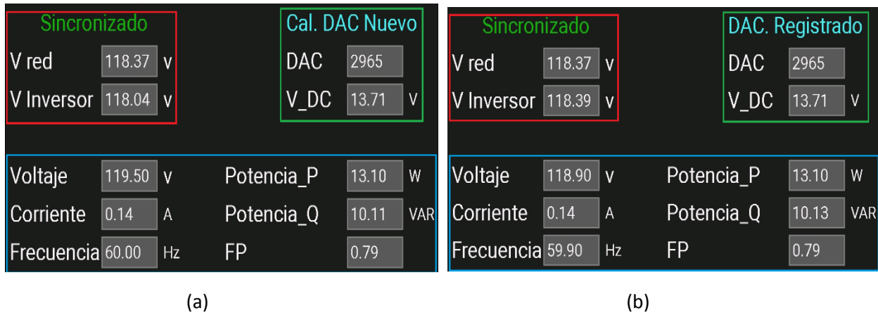
Figura. 62 Sincronización igualando voltaje RMS
