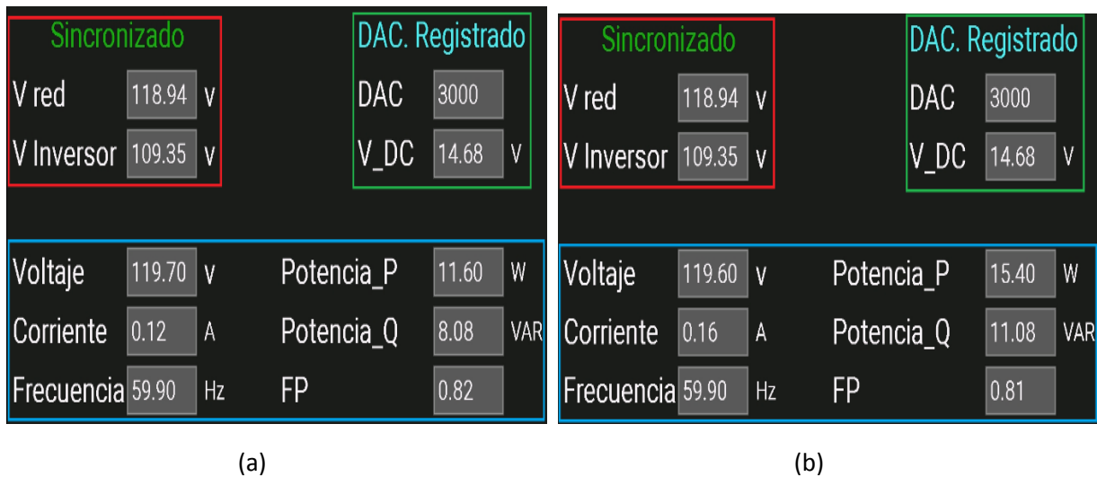
Figura. 64 Sincronización con voltaje RMS más bajo
