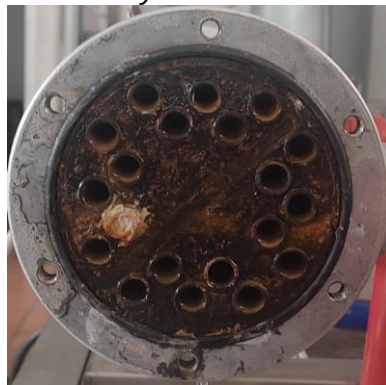
Figura 57. Fallo de obstrucción y atascamiento de (a) un tubo, (b) dos tubos.
