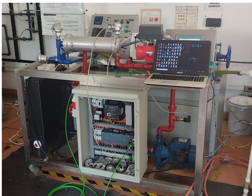
Figura 50. Adecuación del banco de control de temperatura para el desarrollo del experimento
