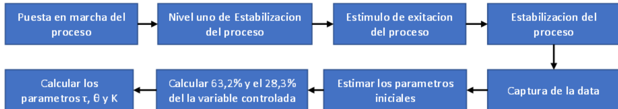
Figura 25. Proceso para identificar la planta con el método de los dos puntos.
