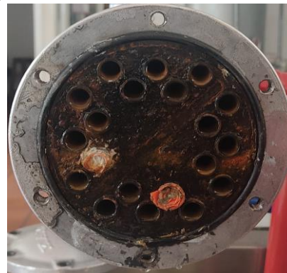
Figura 57. Fallo de obstrucción y atascamiento de (a) un tubo, (b) dos tubos.
