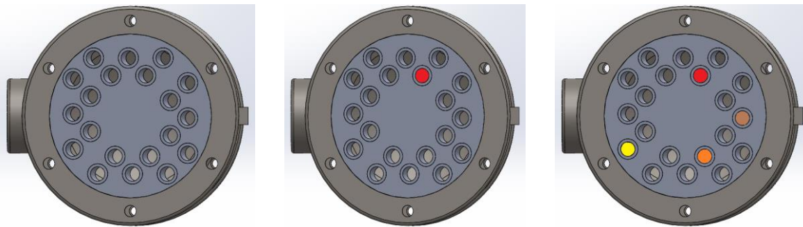
(a) (b) (c) Esquema comparativo del extremo de la tapa móvil, de: (a) extremo con todos los tubos libres, (b) esquema con taponamiento de un tubo, y (c) esquema con múltiples taponamientos
