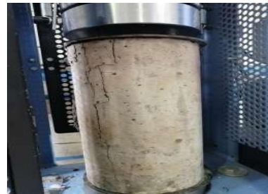
Ilustración 21 ensayo de resistencia a la compresión
