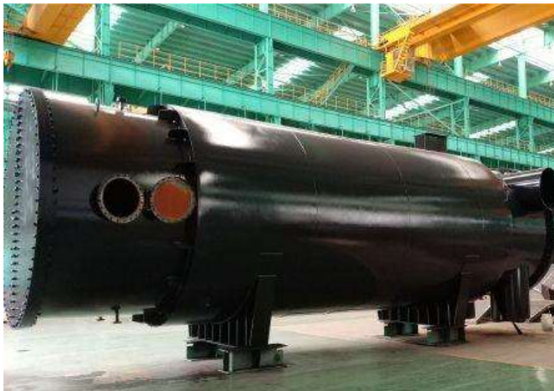
Imagen 10. Condensador de vapor. Fuente: https://www.directindustry.es/prod/shanghai-electric-group-co-ltd/product-206861-2309899.html
