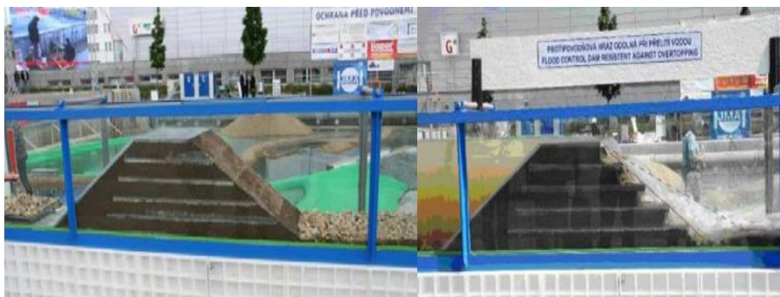
Ilustración 9: Modelo de dique reforzado antes y después del desborde (Vaniček, Jirásko, & Vaniček, 2017)
