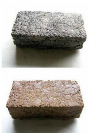
Ilustración 4: Ladrillos hechos de la mezcla de plástico fundido con arena y arcilla. (Vitone YJ et al. 2021).
