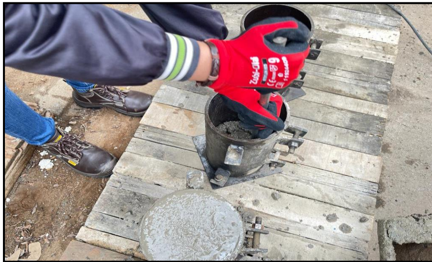
Ilustración 10: Ensayo resistencia a la compresión del concreto.
