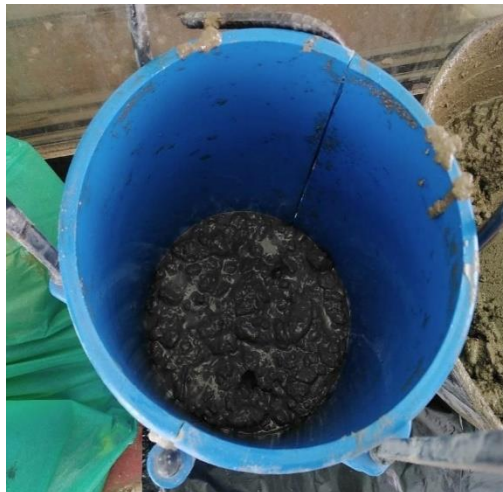
ilustración 55. Compactación ensayo de resistencia al concreto
