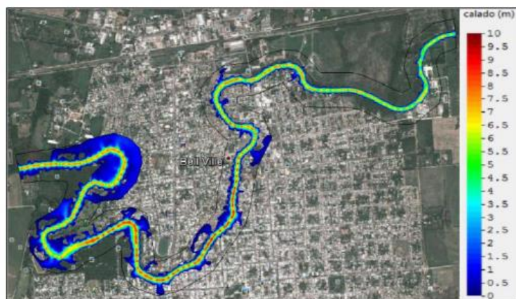
Ilustración 10: Resultados de altura de la lámina de agua en el escenario máximo caudal de avenida torrencial 2015 = 249 m 3 /s
