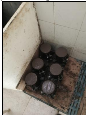
Figura 26, Muestras ensayo a la compresión del concreto.
