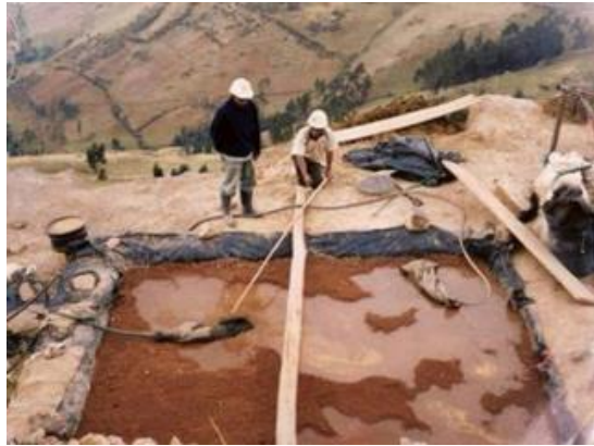
Figura 11. Proceso de Cianuración
