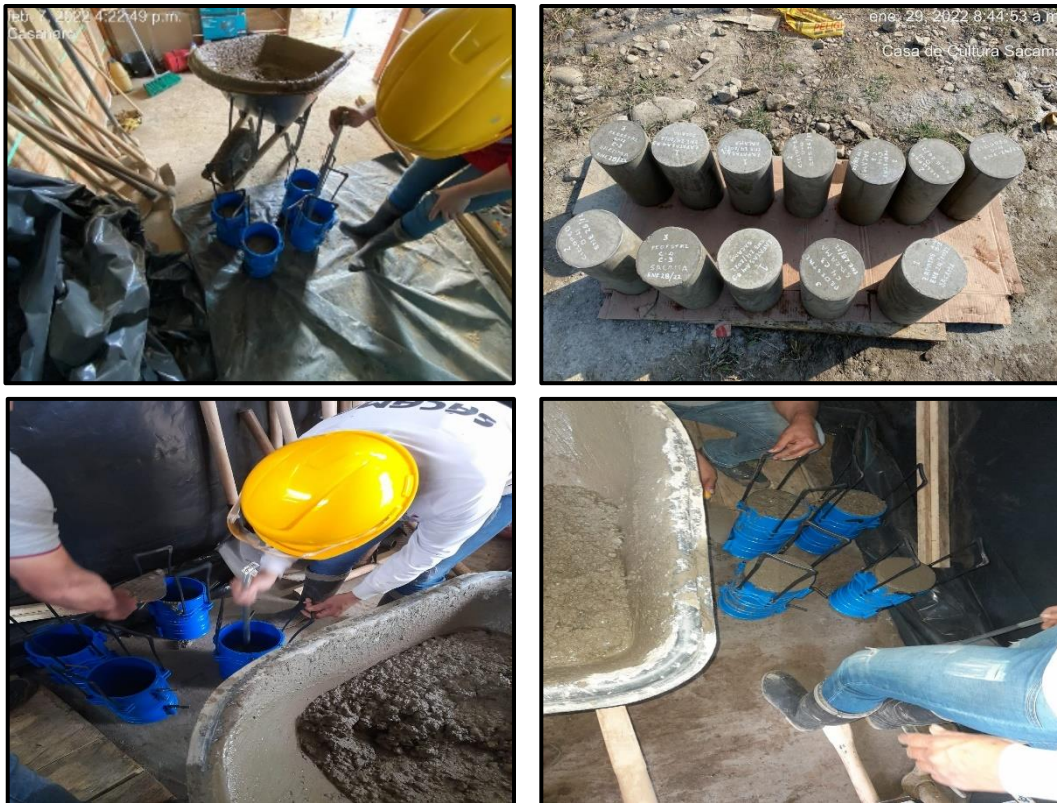
Ilustración 60. Registro fotográfico de toma de muestras para resistencia de concreto.
