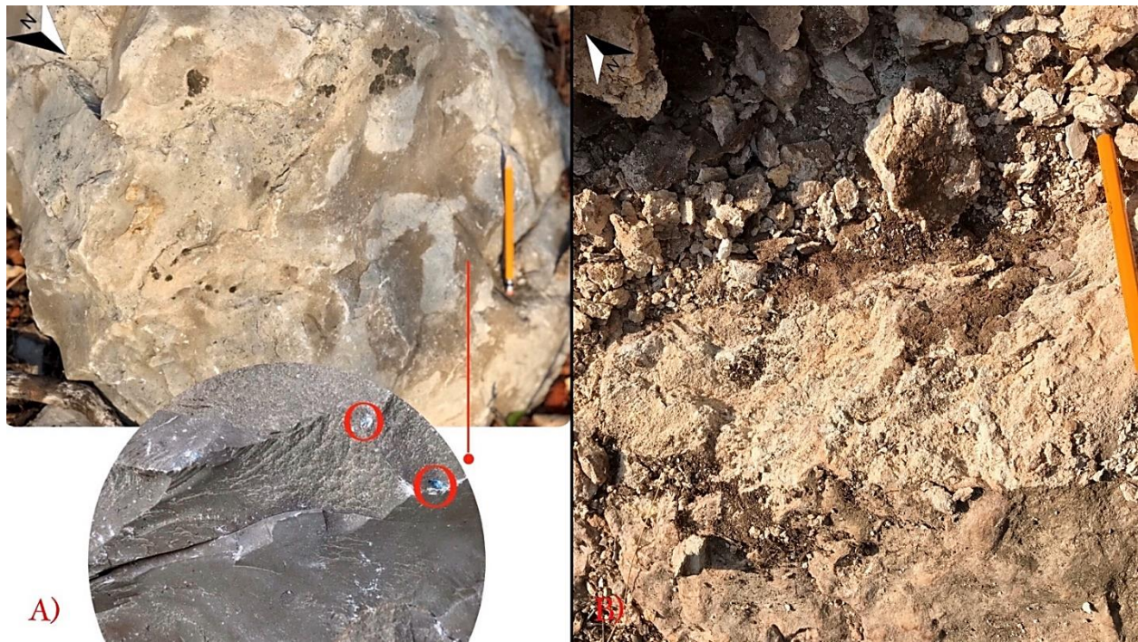
Figura 9: Detalle de las variaciones litológicas. A) mudstone con minerales de fosfato y Terrígenos. B) arenisca calcárea muy meteorizada.
