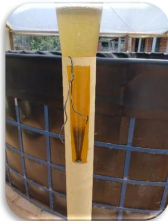
*Ilustración 33. Cono de prueba sedimentación*
