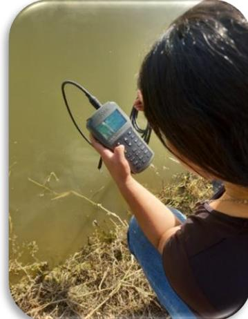
*Ilustración 29. Prueba con Oxímetro*
