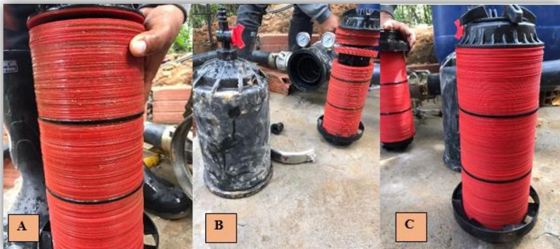
**Nota.** **A** Filtro de disco después de suministrar el riego, reteniendo en su mayoría los agregados que presenta el agua. **B.** Desajuste del filtro para poder lavar todos sus anillos. **C.** Filtro limpio, listo para instalar nuevamente. **Fuente:** Propia
