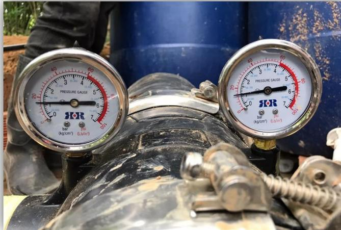
**Nota.** El grafico representa los manómetros ubicados en el filtro para medir presiones de entrada y salida. La presión de entrada y salida no debe ser mayor a 1 bar de presión, de no ser así pueden influir factores como escapes o taponamientos. **Fuente:** Propia
