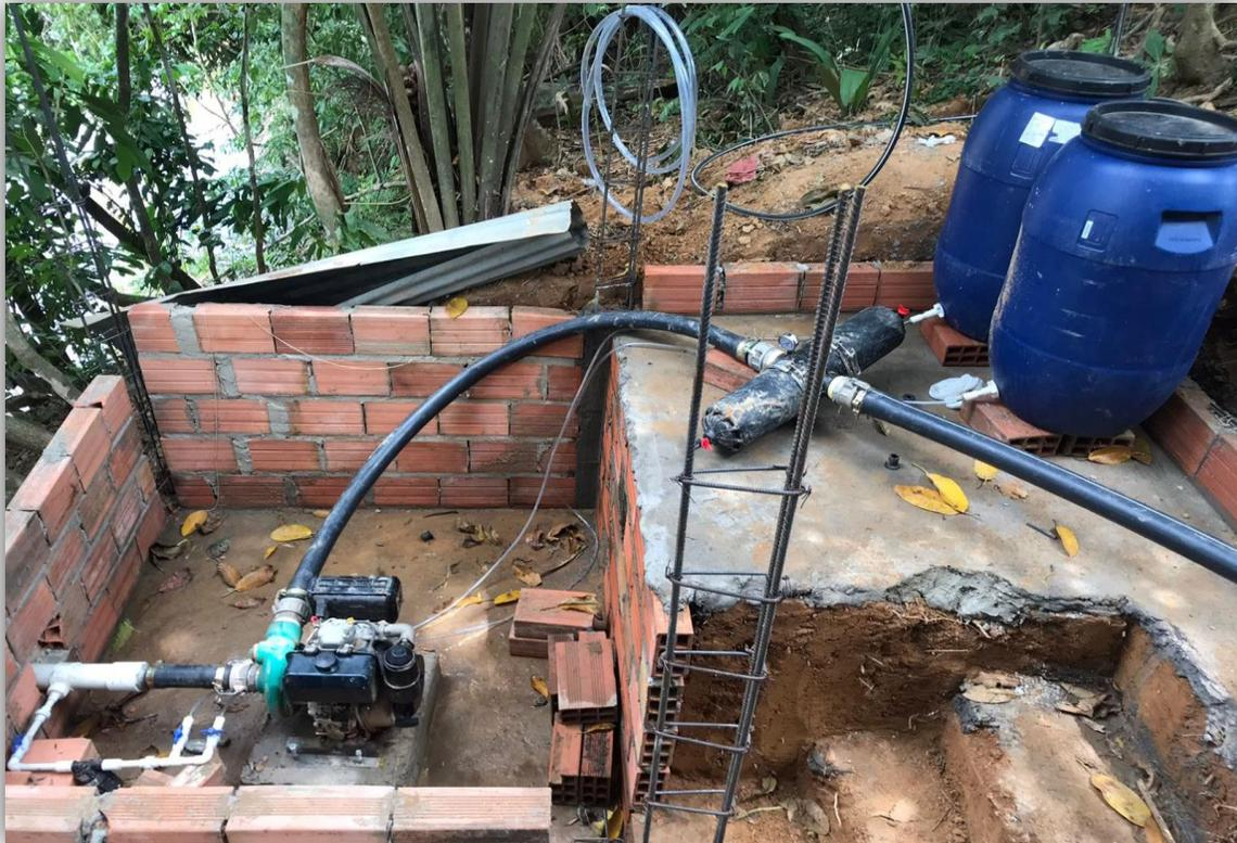
**Nota.** En la figura se observa un cabezal para un sistema de fertirrigación en cultivo de aguacate en etapa inicial, el cual se compone de una motobomba de 3" X 3" con 10 hp (caballos de fuerza). En la parte de la succión se instaló un conducto para transportar los nutrientes desde las canecas de 200 litros hasta la tubería principal con el fin de mezclar la solución nutritiva y el agua. Cabe resaltar que la fuente hídrica es un río por ende en la parte de descarga se instaló un
