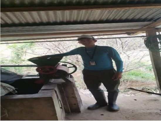
Figura 1. Máquina despulpadora de café.
