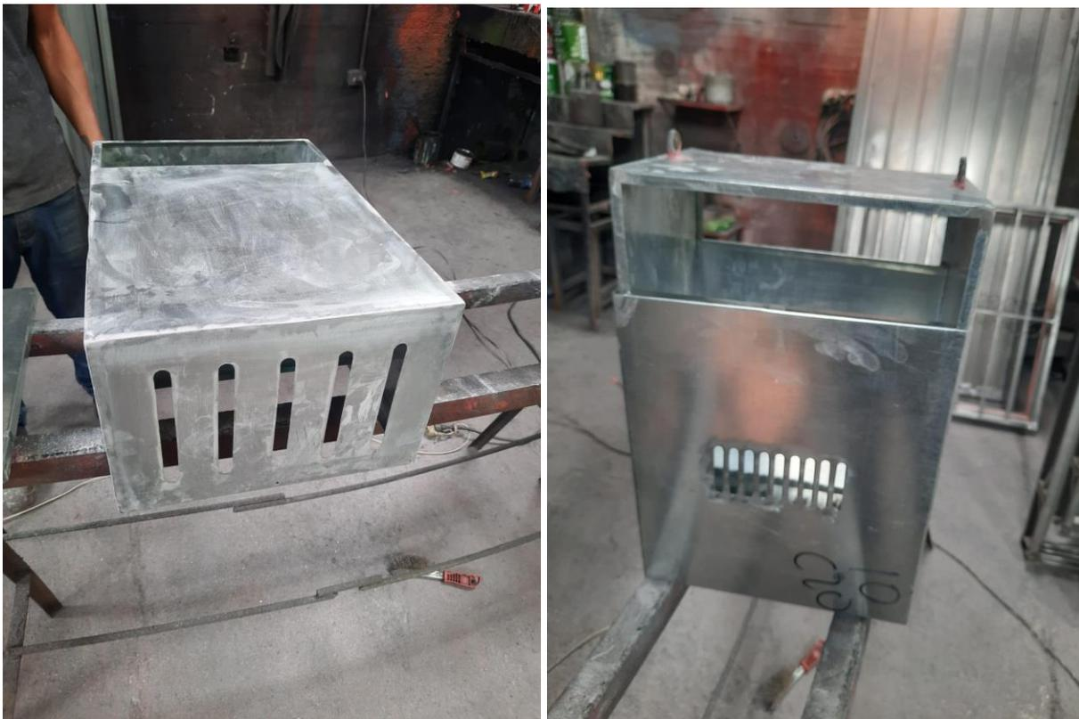
*Imagen 48 Construcción de caparazón y soporte del generador de CO<sub>2</sub>*
