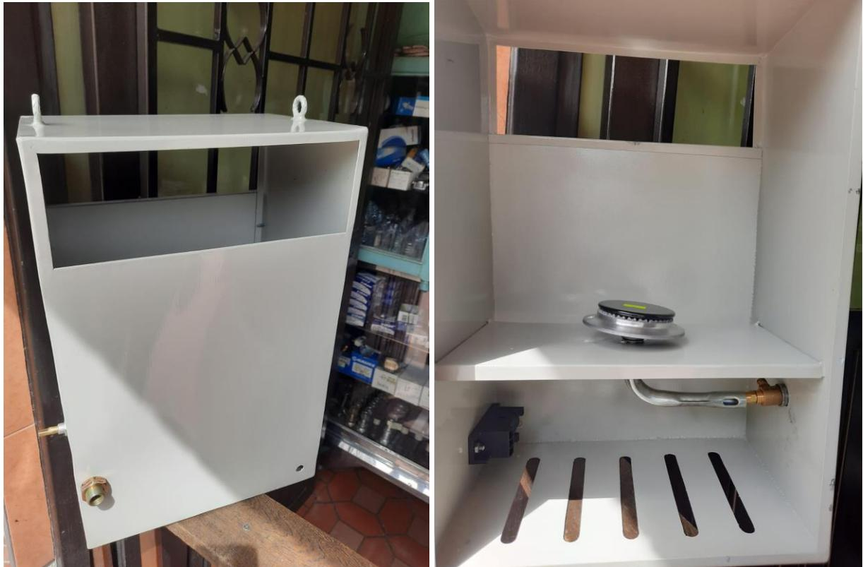
*Imagen 49 Vista frontal e interna del generador de CO<sub>2</sub>*
