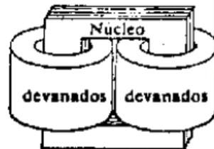
**Figura 4 Devanados de un transformador**
