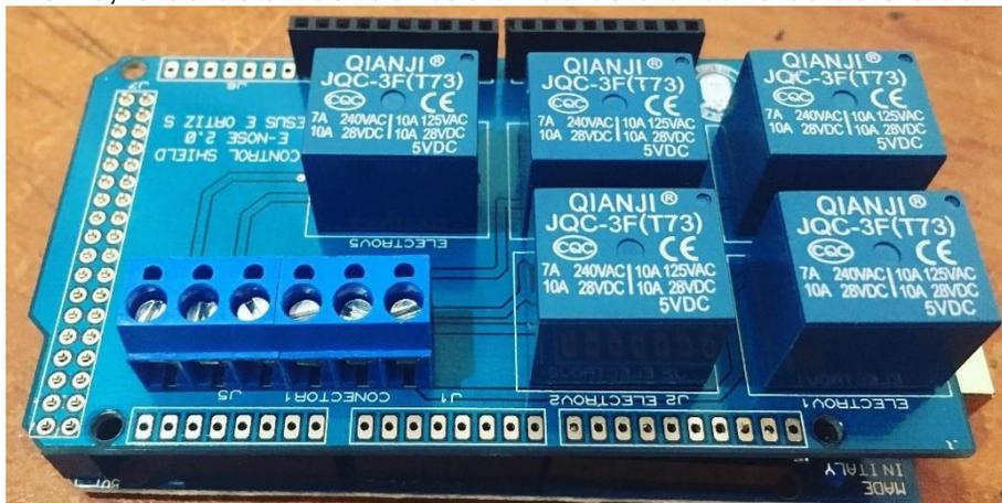
**Figura 16** PCB control de circuito neumático
