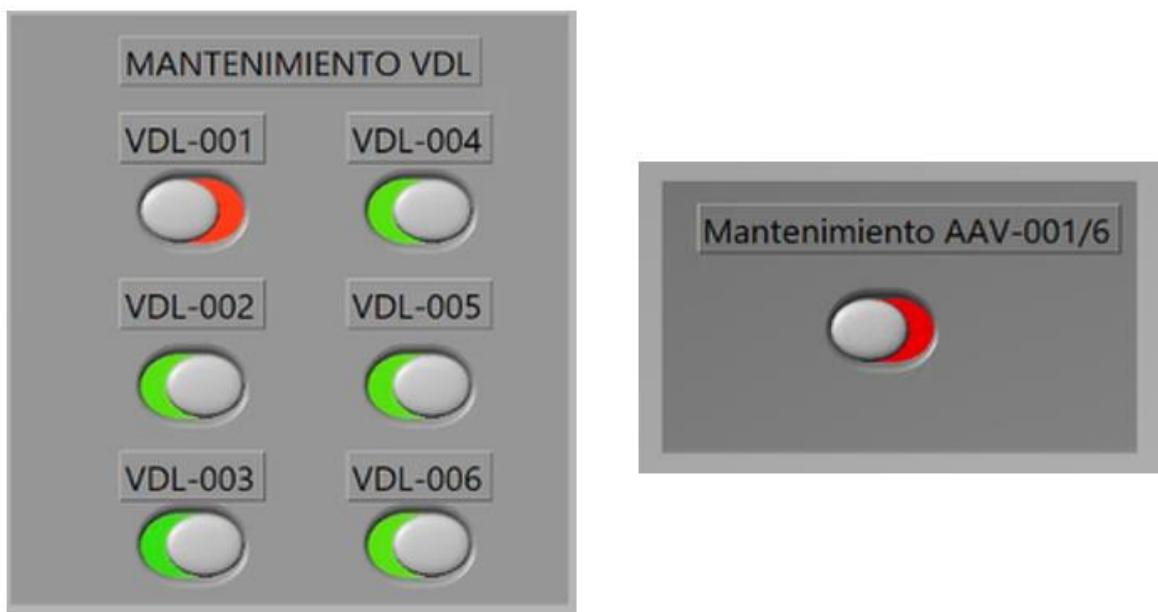
Figura 77. Botonera de mantenimiento en válvula y speakers/strobe
