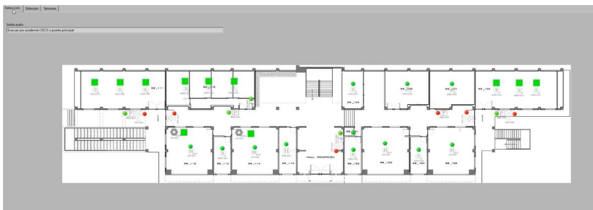
Figura 71. Activación estación manual de alarma y sistema de audio-evacuación
