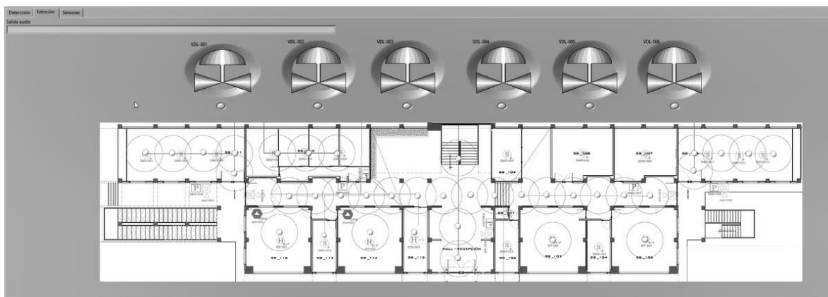
Figura 46. Pantalla principal del HMI Extinción
