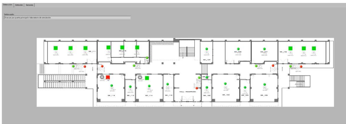
Figura 63. Detección de gas y activación sistema de audio evacuación.
