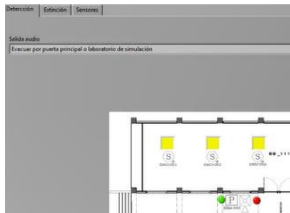
Figura 54. Dispositivos en estado medio de detección y mensaje de audio evacuación.
