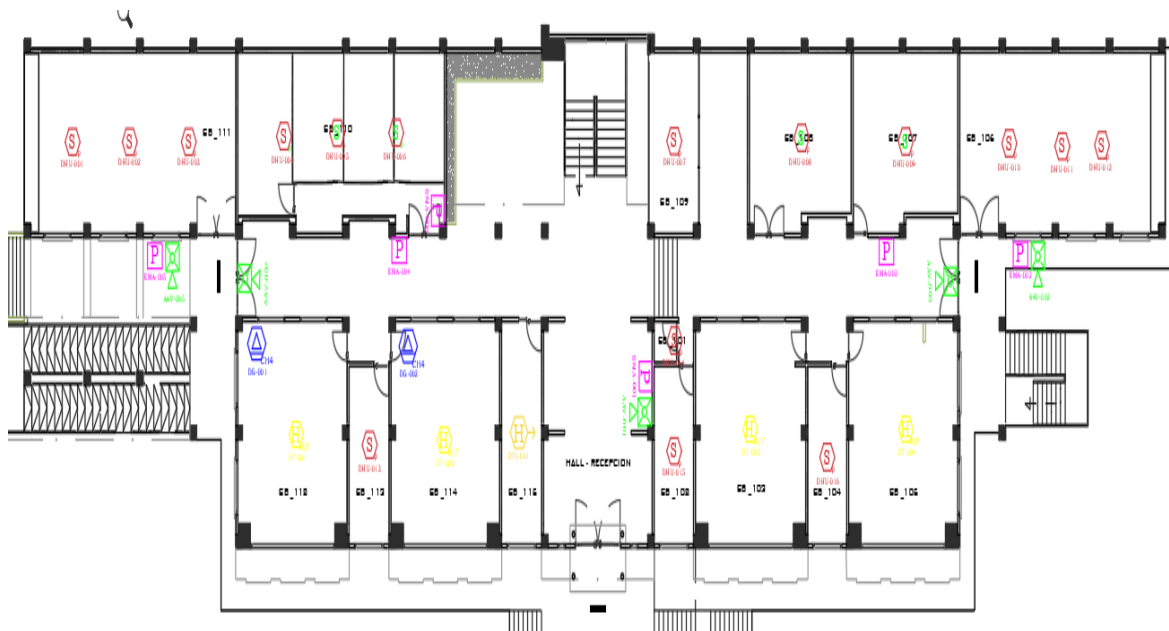
Figura 18. Sistema de detección y alarma Simón Bolívar
