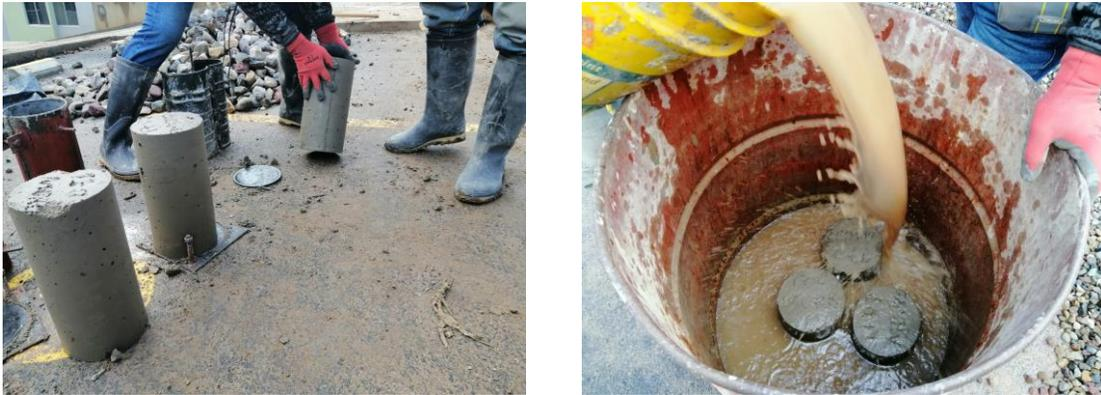
**Ilustración 37 Ensayo de resistencia a la compresión de especímenes cilíndricos de concreto**
