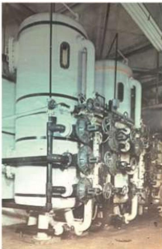
*Figura 19 instalación de una planta a gran escala para tratamiento de biosorción (B Volesky, 2014)*
