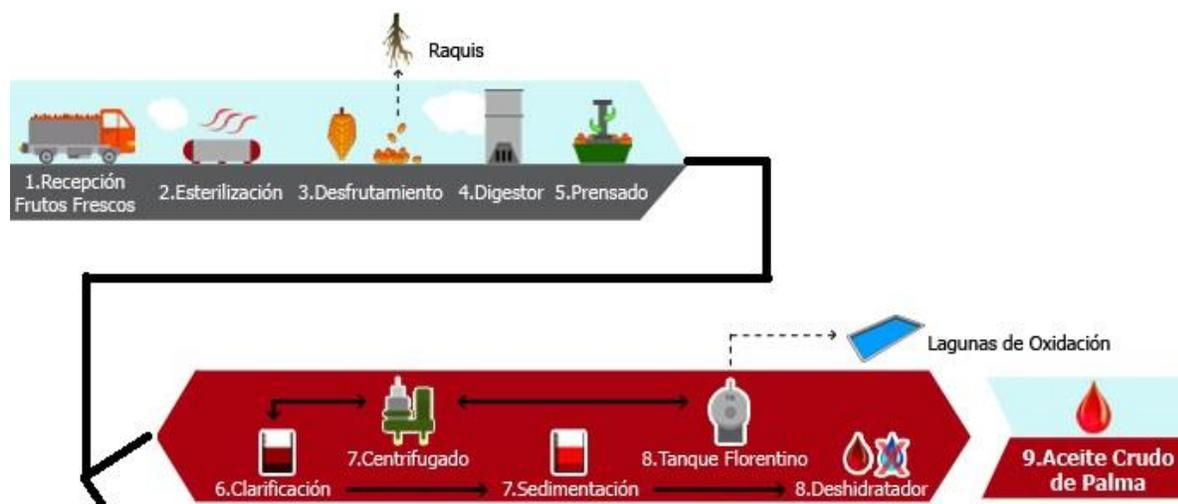
**Figura 6.** Diagrama de Proceso de la Extracción de Aceite de Palma
