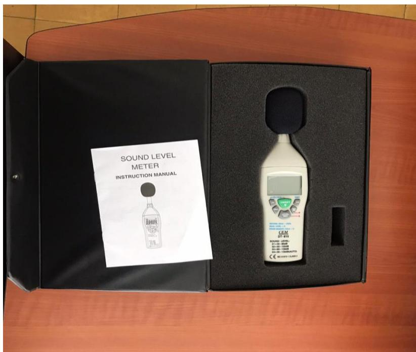
*Imagen 51: Sonómetro utilizado para las mediciones del ruido. Fuente: propia*
