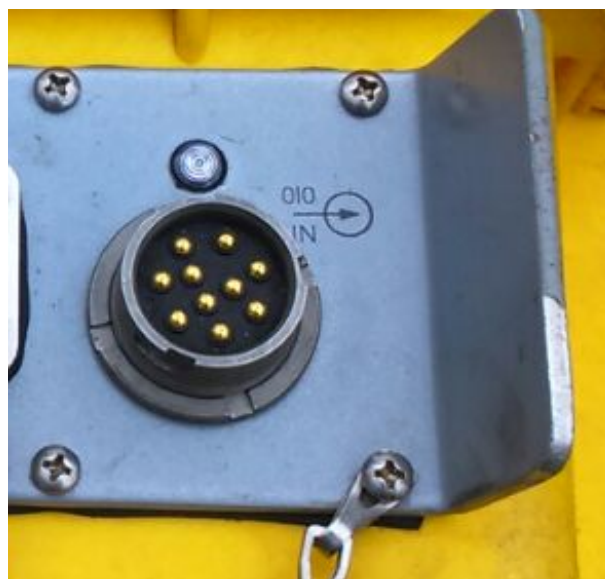
Figura 3.13: Conector que nos permite realizar montajes con sismógrafos en serie.
