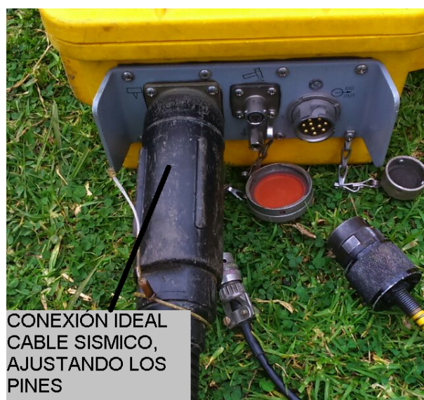
Figura 4.8: Conexión cable sísmico de recolección.
