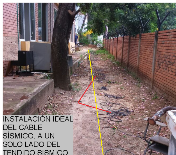
Figura 4.4: Extensión del cable sísmico.
