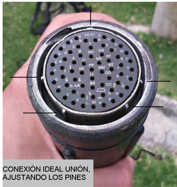
Figura 4.7: Unión del cable sísmico.
