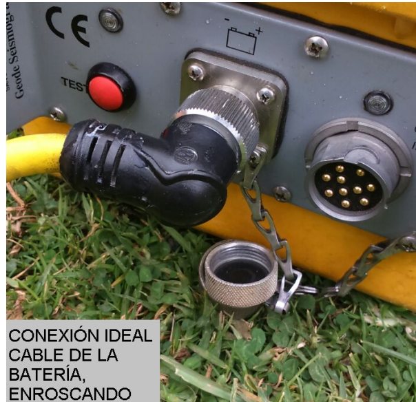
Figura 4.11: Conexión Cable de la Fuente de Energia.
