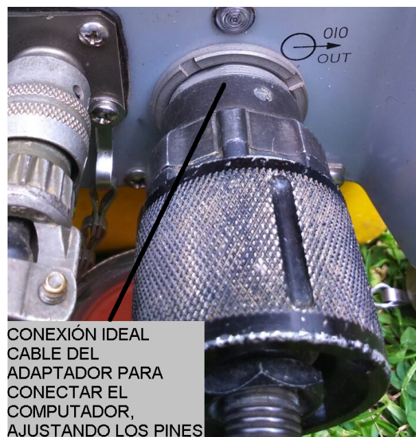
Figura 4.10: Conexión adaptador para conectar el computador.
