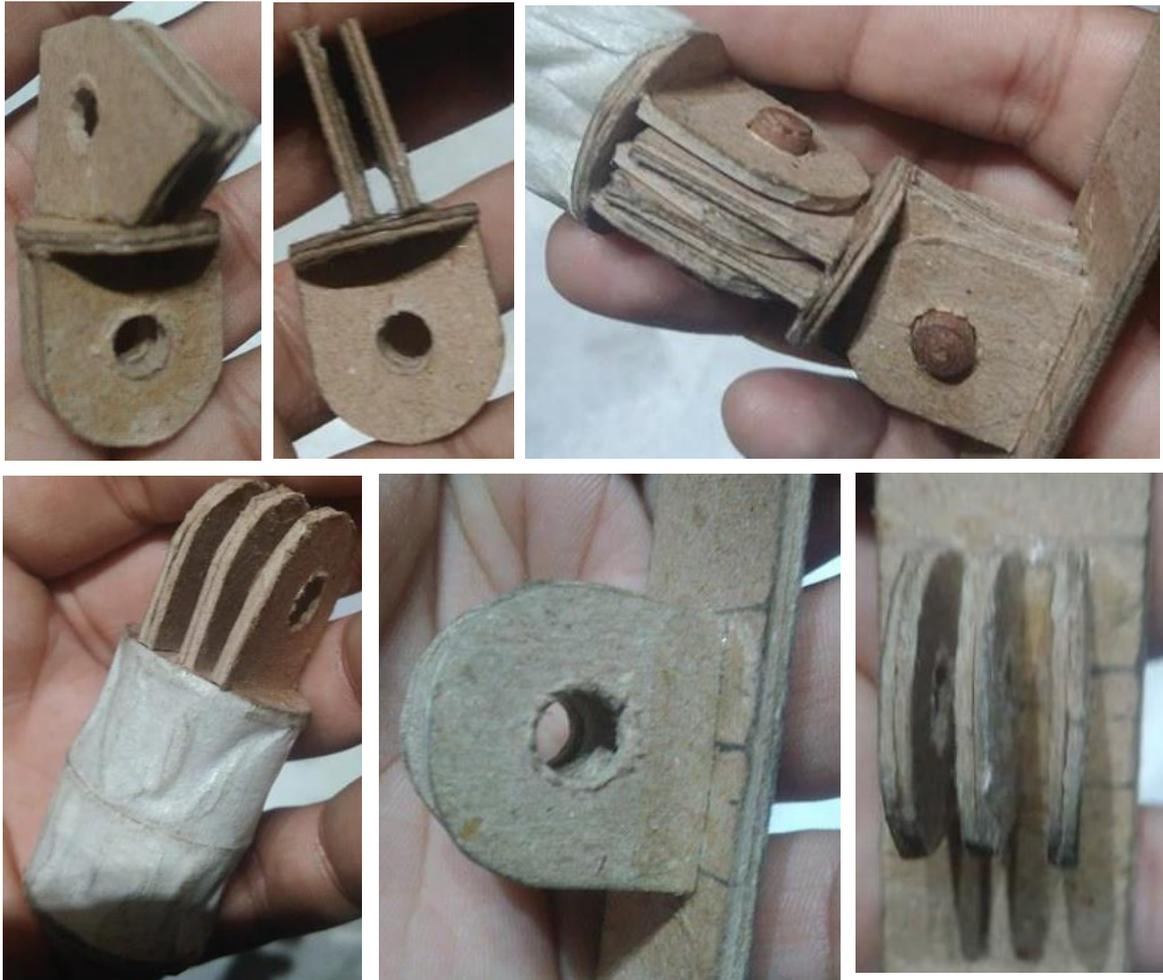
Figura 56. Modelo a escala 1:1 de pieza basculante del soporte de la guitarra.
