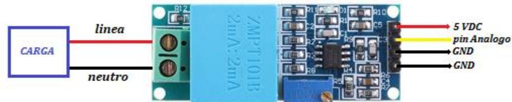
figura 4.16. pines de conexión del sensor ZMPT101B
