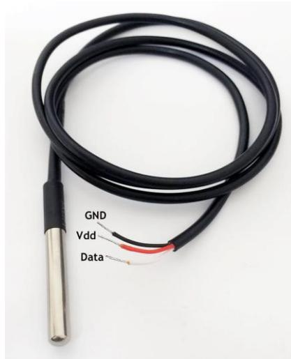
Figura 4.20 Pines del sensor DS18B20
