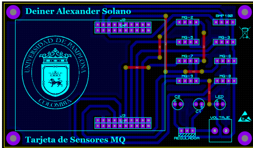
Figura 43. Circuito electrónico de la nariz electrónica en vista 2D
