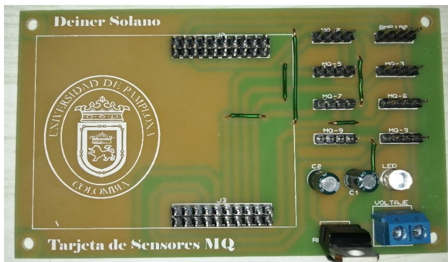
Figura 45. Circuito electrónico de la nariz electrónica en vista real
