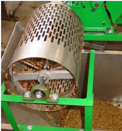
Figura 23 Zaranda Cilíndrica
