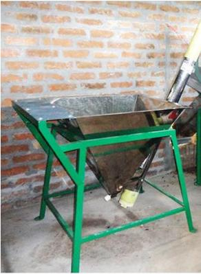
Figura 21 Clasificador Hidráulico Manual
