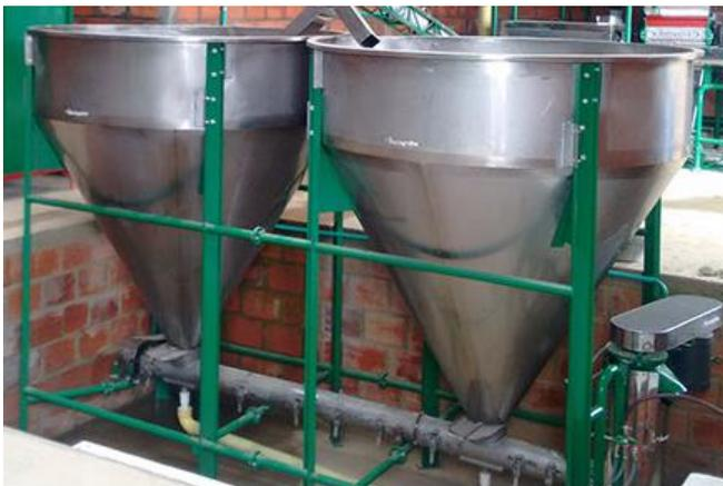
Figura 24 Tanques de Fermentación
