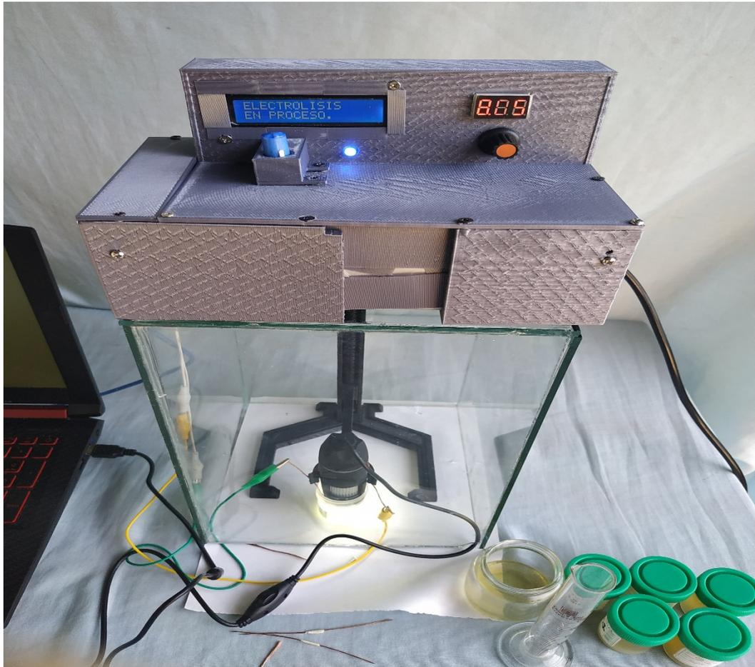
figura 3.18. Muestra de orina en pleno proceso de electrólisis. Autor.
