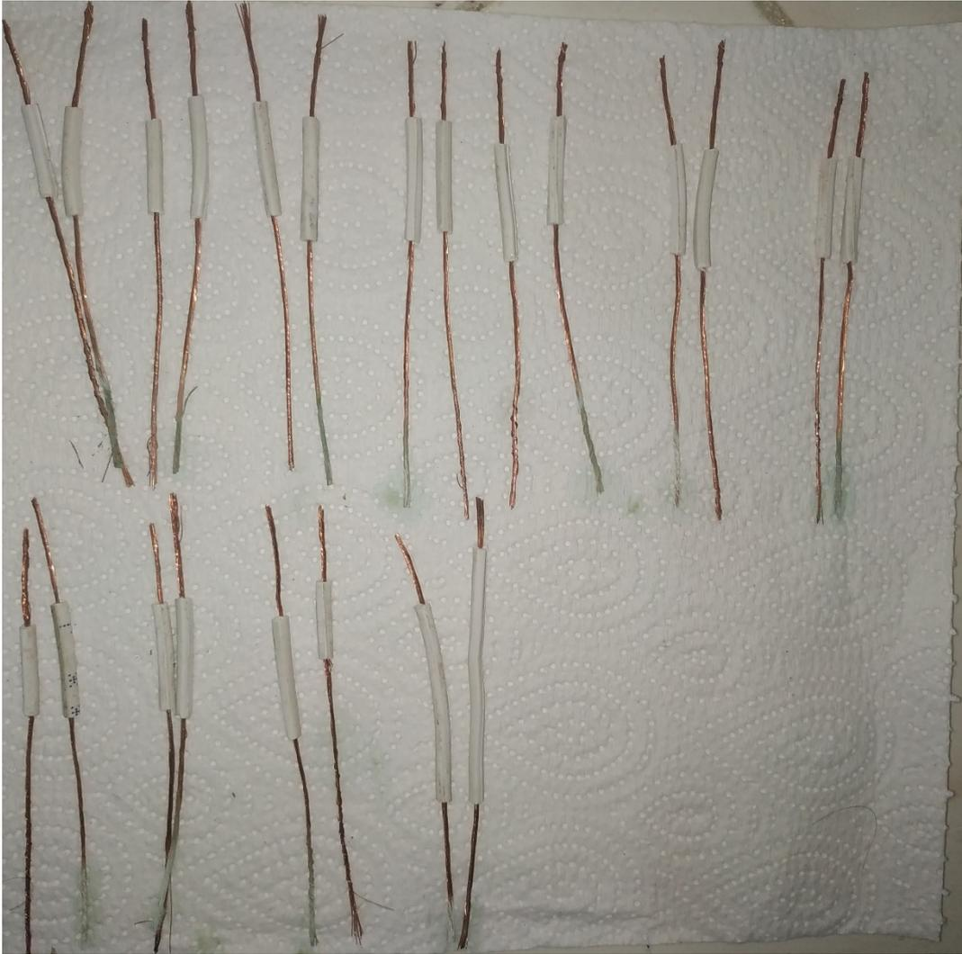
Figura 2.8. Estado de los electrodos una vez culminado el proceso. Autor.
