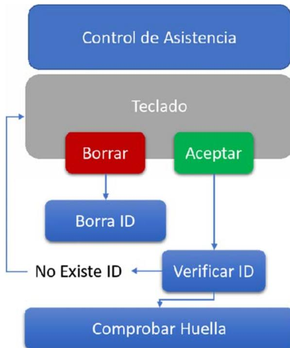
**Ilustración 34** Diagrama de flujo de la primera parte del programa de verificación.
