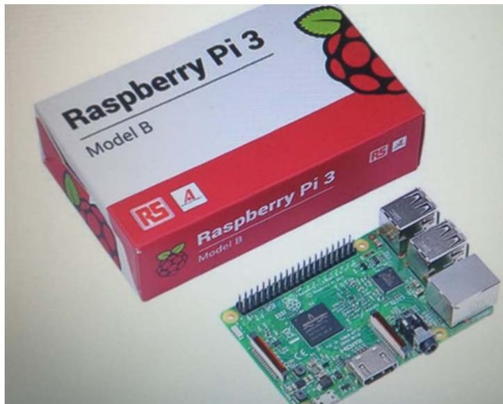
**Ilustración 42: Raspberry PI 3 Model B**
