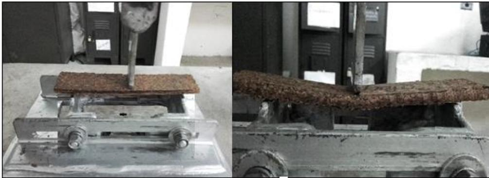
**Figura 10.** Prueba de flexión estática en probetas
