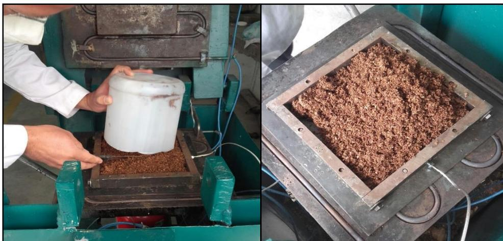
**Figura 8.** Proceso de llenado para termo conformado.
