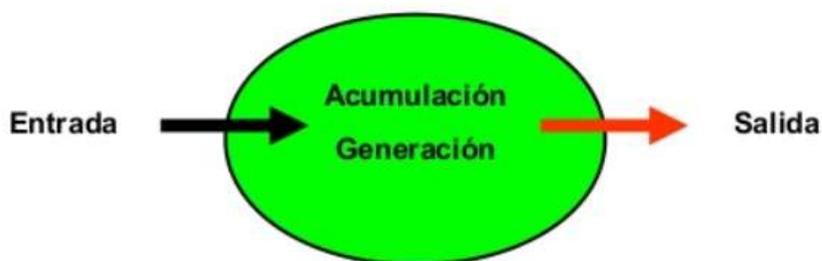
Figura 16 Esquema general de la conservación de la masa y la energía.<sup>24</sup>.
