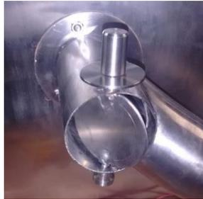
**Figura 30.** Damper del equipo de deshidratación
