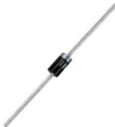
Nos brindó seguridad a nuestra placa de arduino, al colocarlo en paralelo con el relé permite el flujo de corriente en una sola dirección y evita corrientes inversas, lo cual podría quemar nuestra placa.
