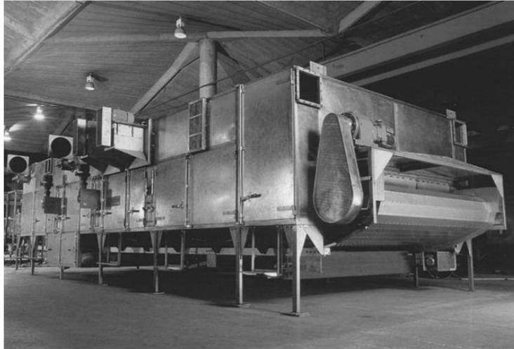
**Figura 6.** Deshidratador de cinta transportadora.
