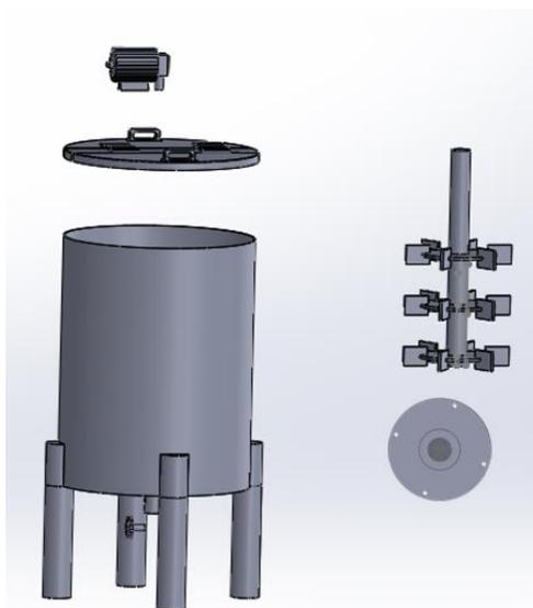
*Ilustración 9* partes ensambladas del macerador
