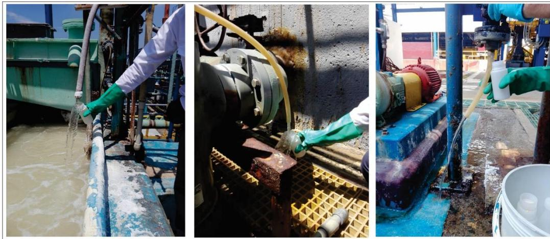
*Imagen No 4.1. Puntos de muestreo para control de calidad por analistas de Laboratorio*
