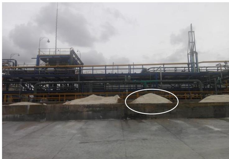
**Imagen 4.9. Altura de la masa de Sal en el Lixiviador durante aporte constante**
