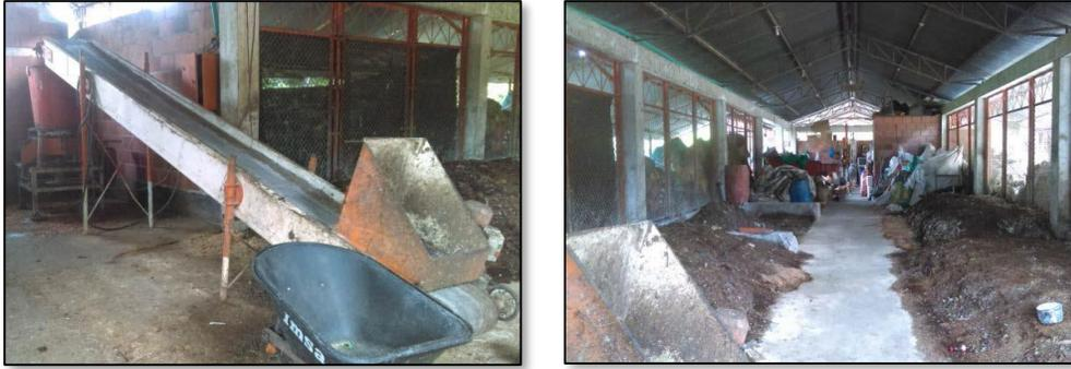
**Figura 10.** *Maquina picadora y espacio de secado*
