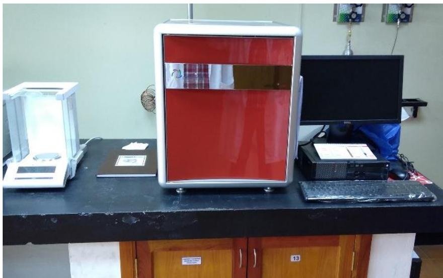
Figura 5. Equipo de análisis elemental por combustión, modelo Vario Micro Cube, fuente (Autor)
