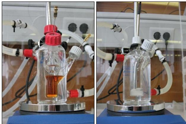
**Figura 3.3.** Celdas de líquido-líquido.
