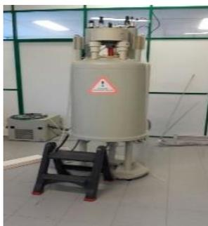
**Figura 2.2.** Espectrómetro Bruker Avance III de 400 MHz.
