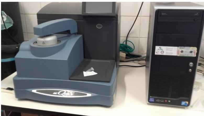
**Figura 2.4.** Calorímetro diferencial de barrido (DSC), TA Instruments Modelo Q500.
