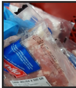
Ilustración 21. Paquete de carne molida refrigerada con desprendimiento en selle por presencia de grasa.
